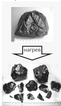
Рис. 1. Тектиты, чрезвычайно закаленные стекла. Даже медленный нагрев привел к мгновенному разрушению образца нижегородского тектита.
